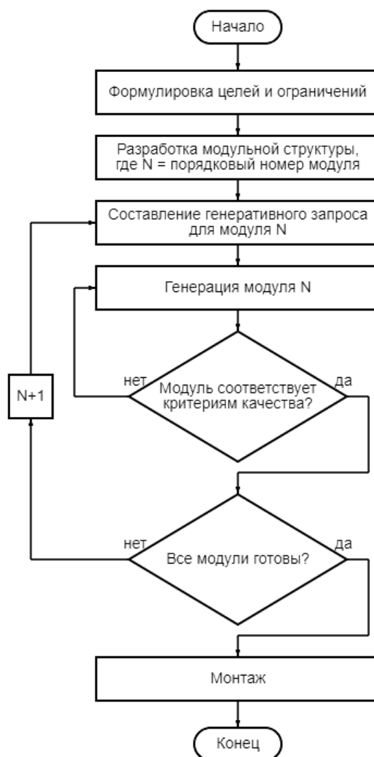
Рисунок 1. Блок-схема итерационной методики
